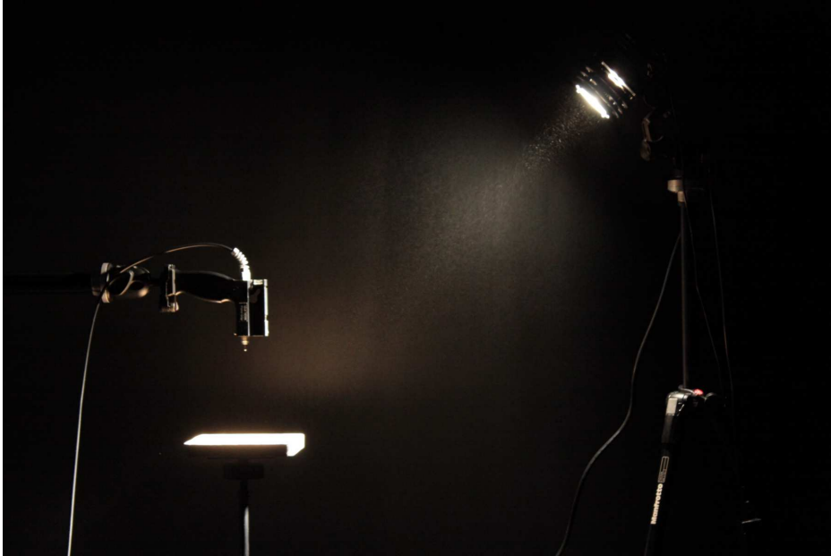
1. ábra. A mérési elrendezés: balra középen az érzékelő, alatta a tárgyasztal, jobbra fenn a megvilágító fényforrás.
