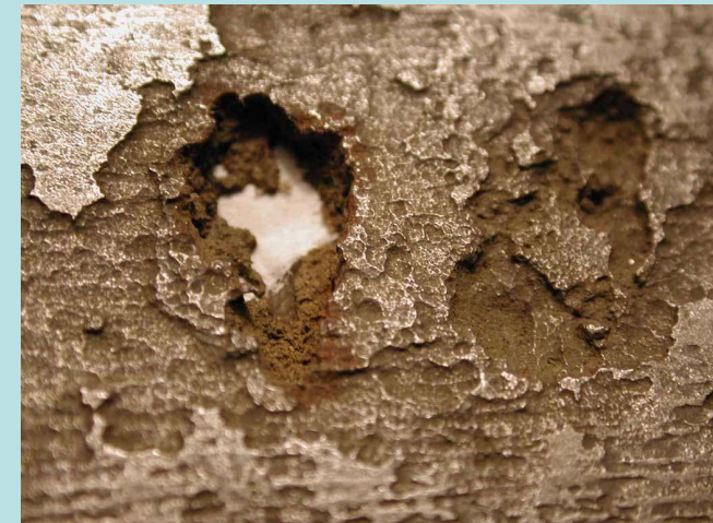
Fűtőolaj tartály kilyukadt fala. Gyakori korróziót okoz az olajiparban.
