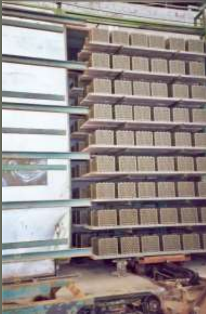
13 A kiszárított agyag kijön a szárítóból
