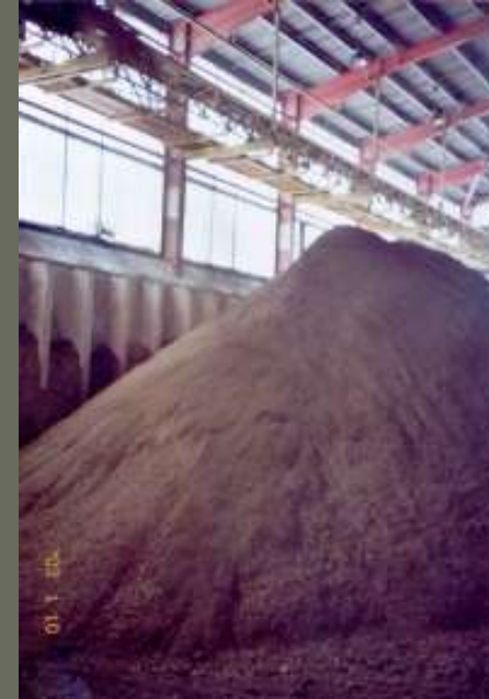
06 Az összegyűjtött agyag és fűrészpor keverék a pihentetőben
