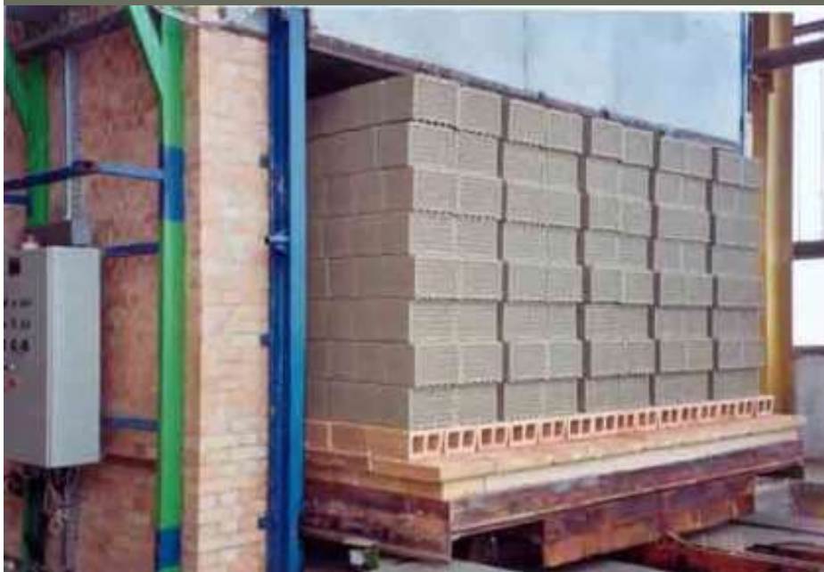
15 A kiszárított téglá elkezd újat a kemencében
