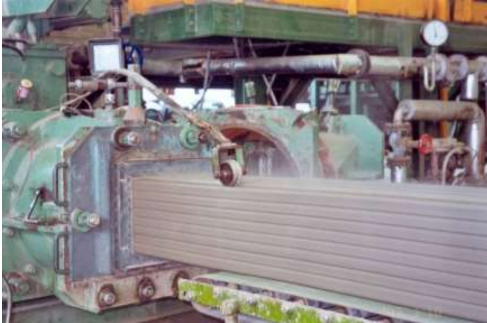
09 A szájnyláson keresztül a formázott anyag kikerül a présből
