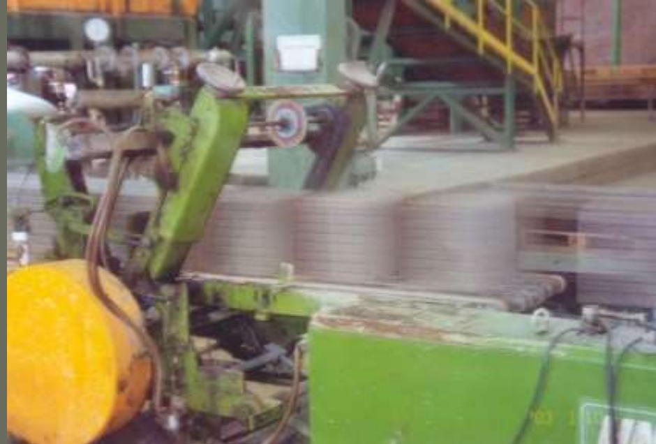
10 A téglakígyót a daraboló megfelelő méretre vágja
