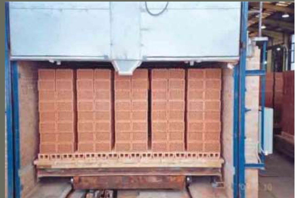
16 A kiégetett téglá kijön a kemencéből
