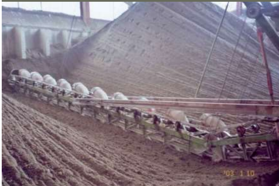
07 Az összeőrölt agyag és fűrészpor keverék a pihentetőben
