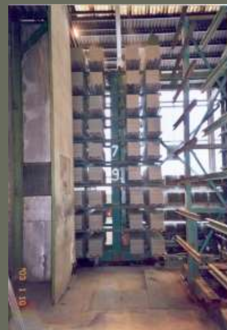
12 A formázott agyagtermék a szárítón végighalad
