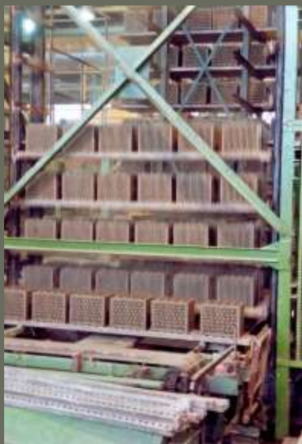
11 A téglafarmájú agyag a szárító-kocsira kerül
