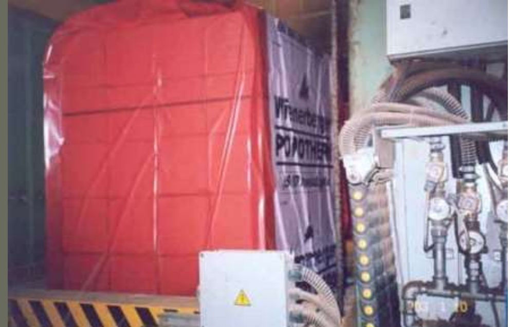
18 A csomagológép a zsugorfóliát rámelegíti a rakatra
