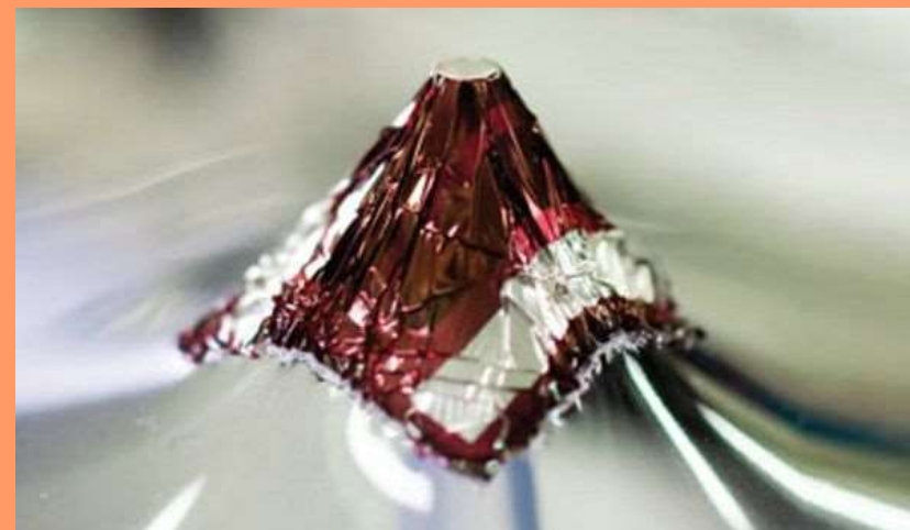
Ultravékony napelemfólia két mikrométer vastag.
