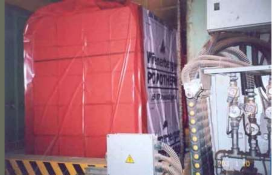
18 A csomagológép a zsugorfóliát rámelegíti a rakatra
