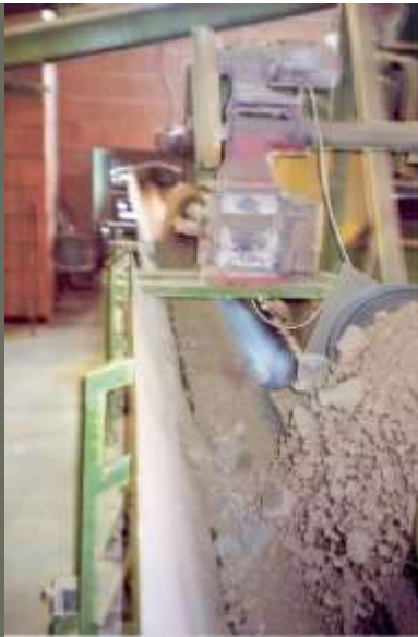
05 Agyag és fűrészpor őrlőgépeken halad keresztül
