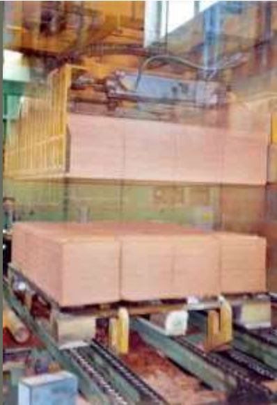
17 A kemence-kocsiról az ürítő rakodó gép a raklapra helyezi a téglát
