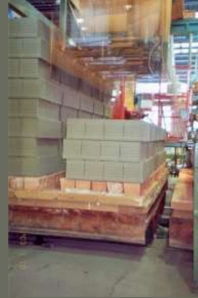
14 A kiszárított terméket a rakodógép a kemence-kocsira rakja
