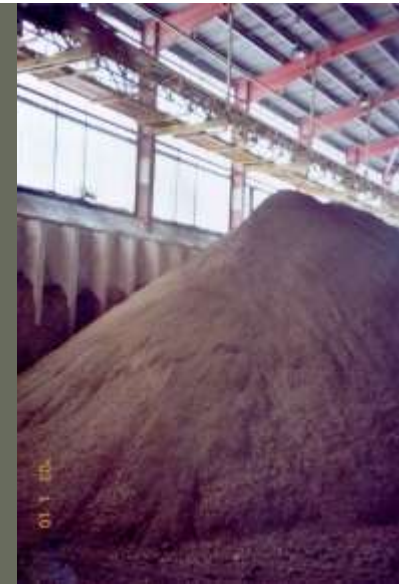
06 Az összegyűjtött agyag és fűrészpor keverék a pihentetőben
