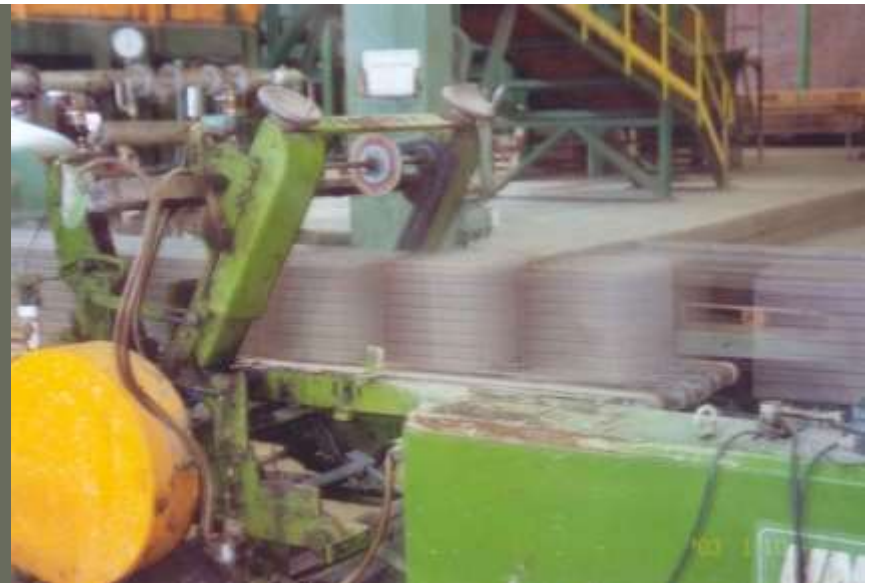
10 A téglakígyót a daraboló megfelelő méretre vágja
