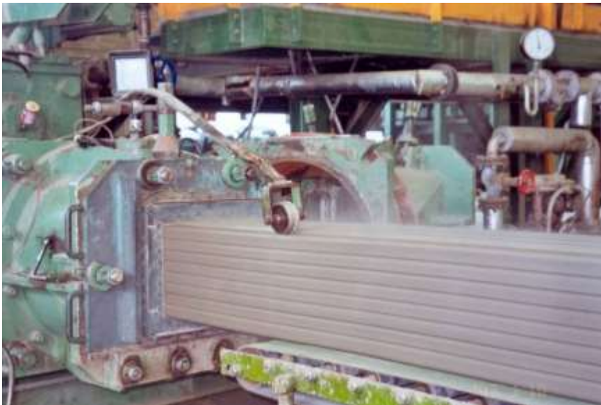
09 A szájnnyíláson keresztül a formázott anyag kikerül a présből
