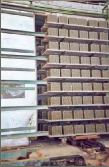
13 A kiszárított agyag kijön a szárítóból
