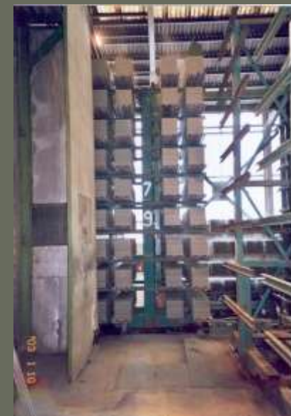
12 A formázott agyagtermék a szárítón végighalad
