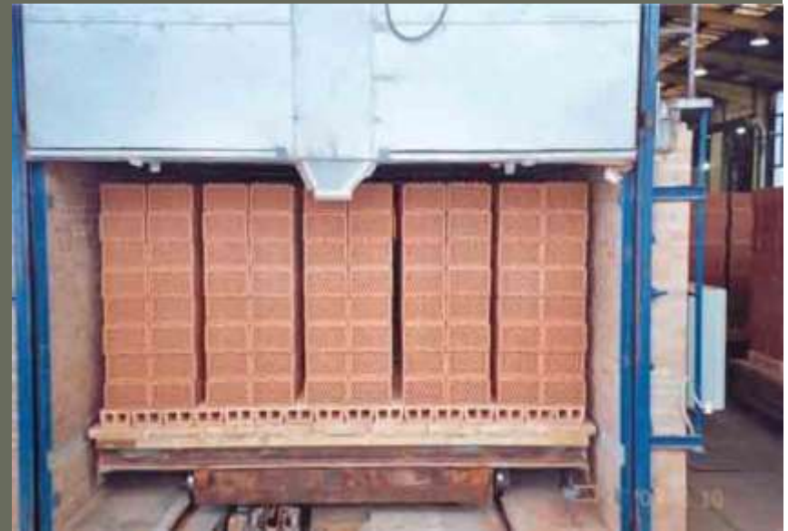
16 A kiégetett téglá kijön a kemencéből
