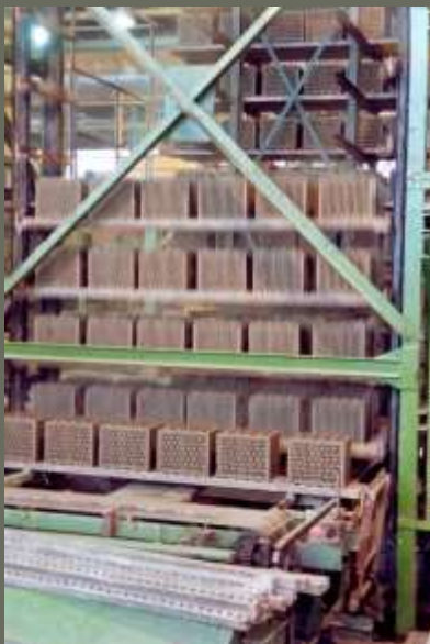
11 A téglafomájú agyag a szárító-kocsira kerül
