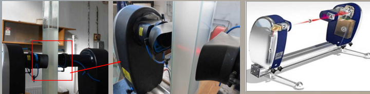
1. He-Ne lézer, 2. Kollimációs optika, 3. Mérési zóna, 4. Fourier lencse, 5. Foto dióda, 6. Adatgyűjtő rendszer
