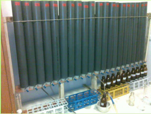
1. ábra A vizsgálatokhoz használt 20 db talajoszlop, és mintavétel a 10. oszlopból.
