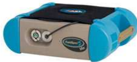
2. ábra ASD FieldSpec 3 MAX hordozható spektroradiométer Figure 2. ASD FieldSpec 3 MAX portable spectroradiometer (ASDInc. 2010)
