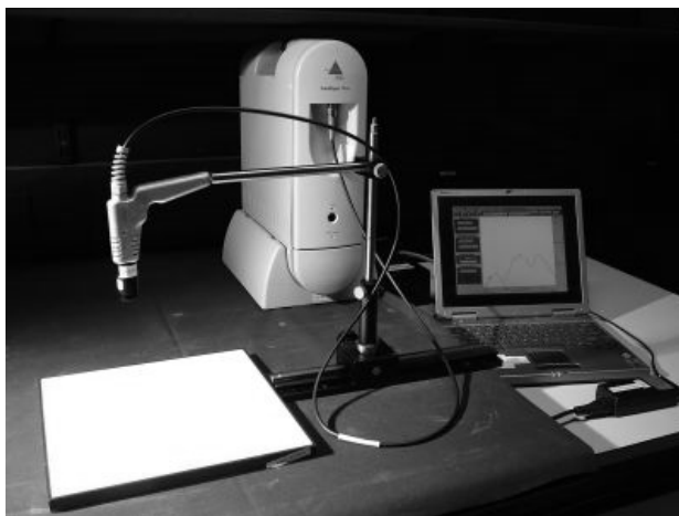
9. ábra Egy példa az ASD FieldSpec-el történő labori mérésre
